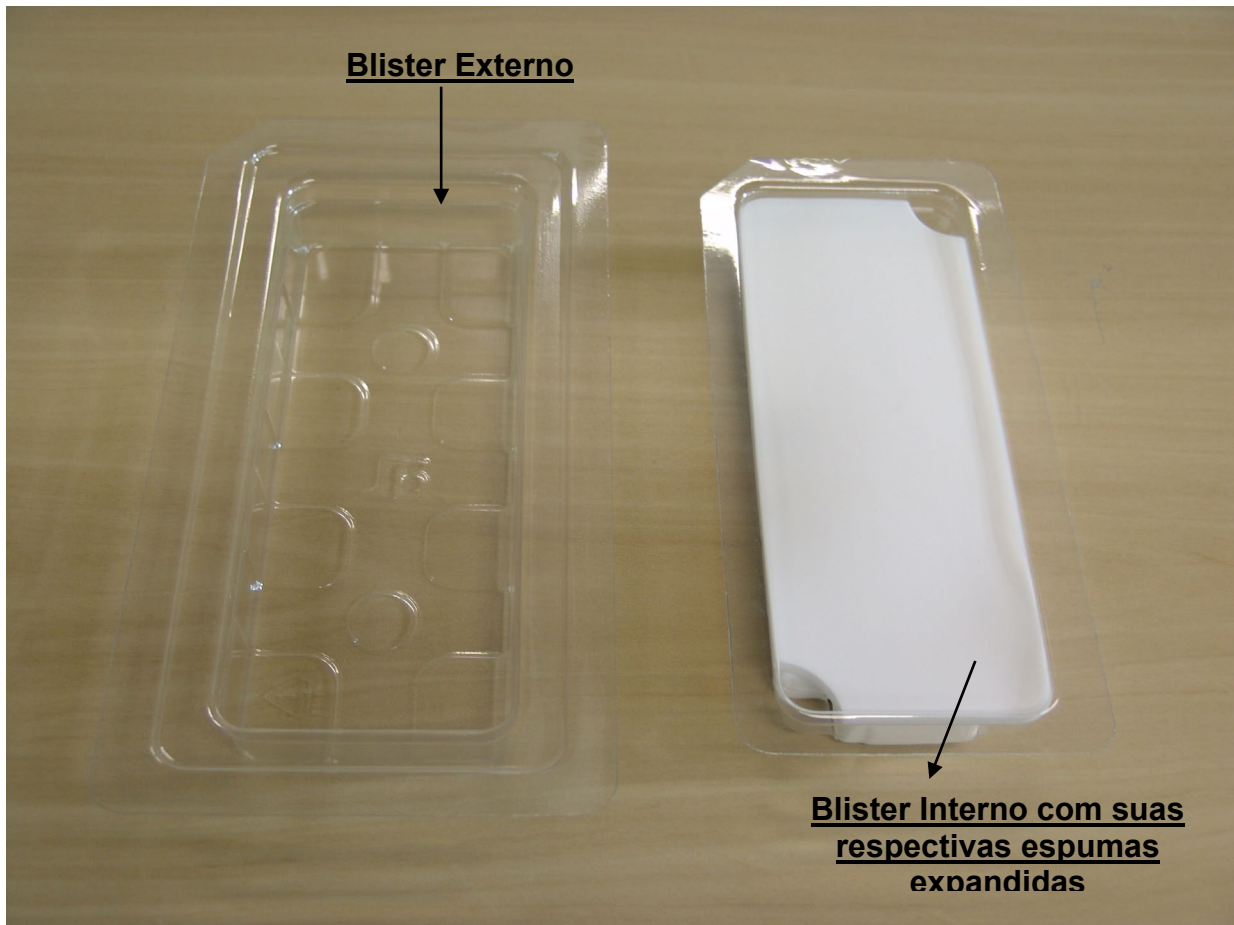
Figura 5: Blister interno e blister externo
